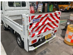
軽トラックにリヤ垂直ゲート架装
